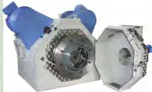
MAXIMA 620...700 Output 1.500 bis 3.500 kg/h Antriebe von 150 bis 220 kW
