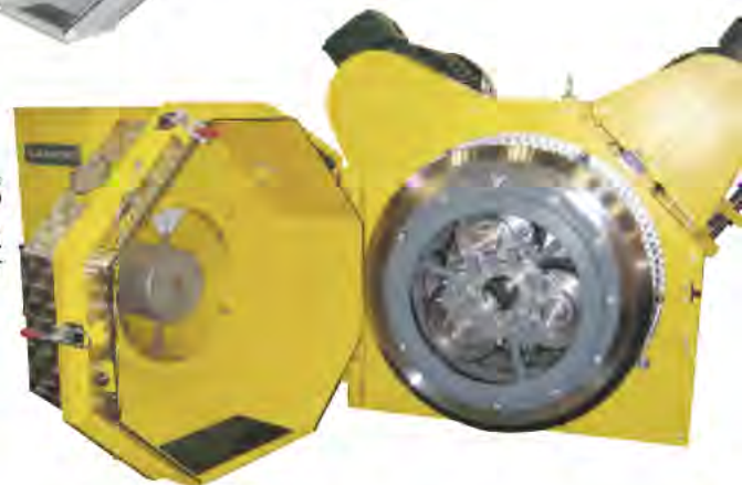
MAXIMA 840-125 Output 3.500 bis 5.000 kg/h Antriebe von 264 bis 320 kW
